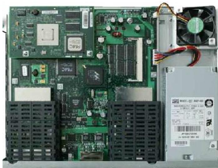
Gambar 1.2. Bagian dalam router
